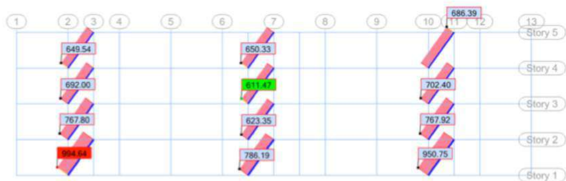
1.21 Optredende spanningen in de stabiliteitsverbanden ( q = 1 ).
