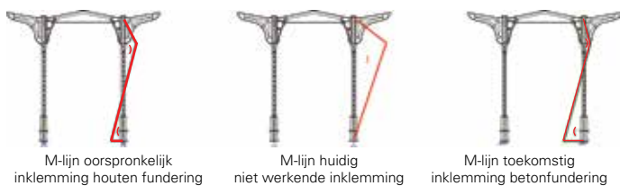
17. Links oude situatie zonder inklemming. Rechts situatie met nieuwe inklemming.
