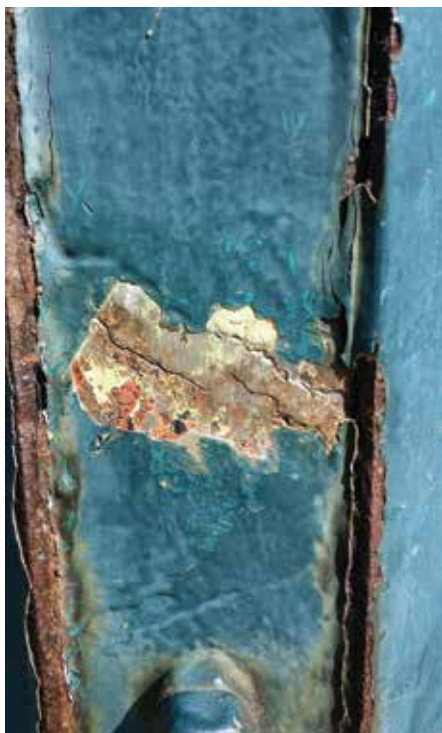
11. Las in gietijzer scheurt door laskrimp.
