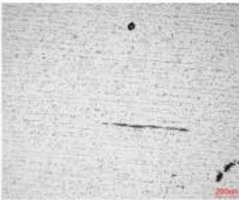
Figuur 5.1: V3 kolom, microstructuur kern
