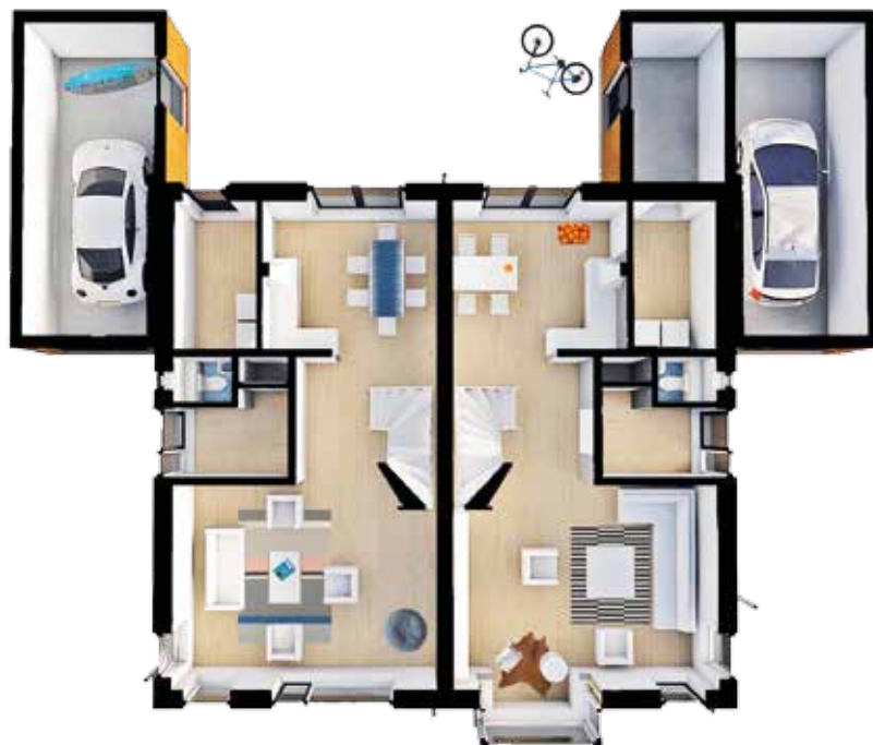
De garages zijn constructief los geknipt van de woning voor een regelmatige plattegrond.
