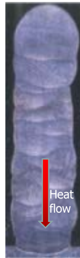
R. Seijffers AISI316L/GTAW Transverse cross Section
