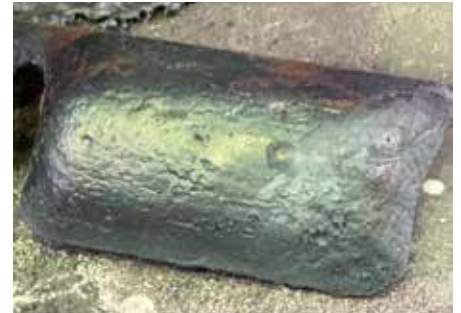
Eindproduct. Compact broodje staalschroot (± 7 kilo).
