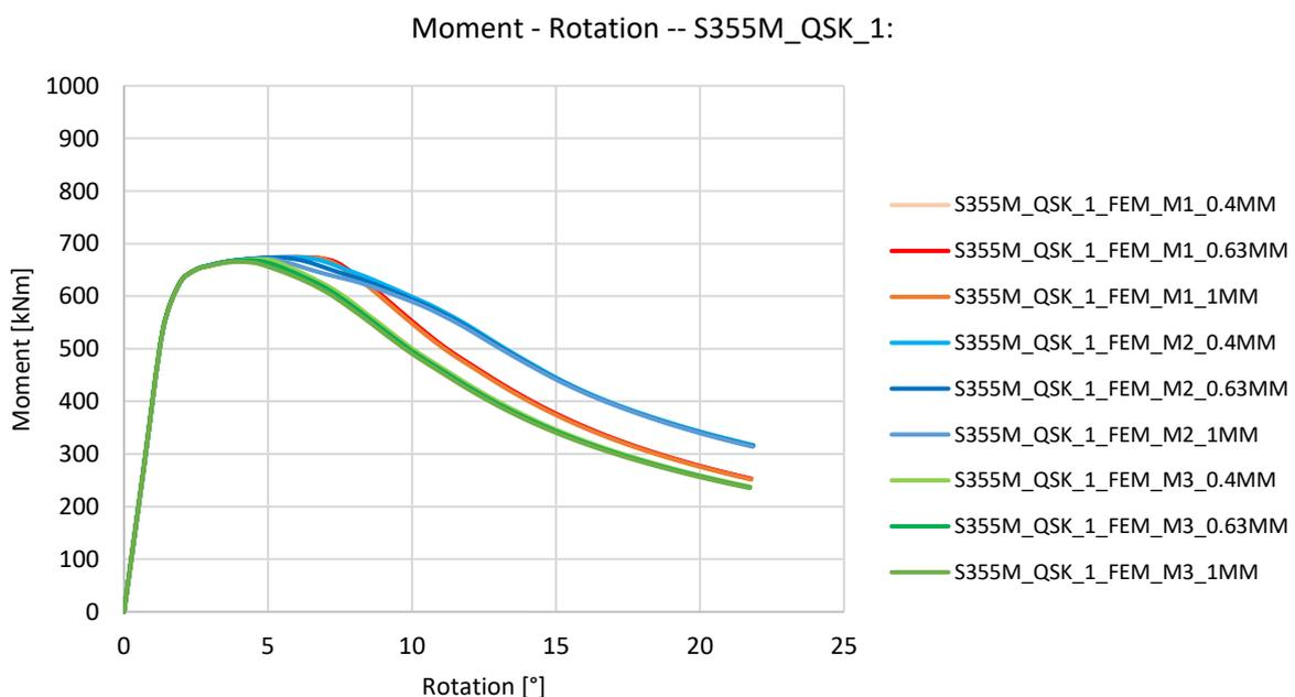
Figur 35: Momenten-Rotationsverhalten der FEM-Berechnungen der drei untersuchten Modes (M1, M2 und M3) und deren Variation mit Amplituden von (0.4 mm, 0.63 mm und 1 mm) dargestellt für den S355M\_QSK\_1 Träger
