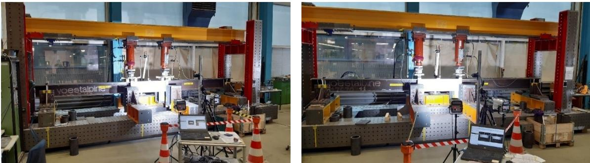
Figur 15: Ausgangslage der physischen Experimente vor dem Start mit fertigem Aufbau und installierter Messtechnik am Beispiel des S460M\_QSK\_1 (links) und S355M\_SF\_QSK\_1 (rechts)
