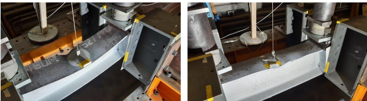
Figur 16: Erste Anzeichen von lokalen Instabilitäten im Druckflansch am Beispiel des S460M\_QSK\_1 (links) und S355M\_SF\_QSK\_1 (rechts)
