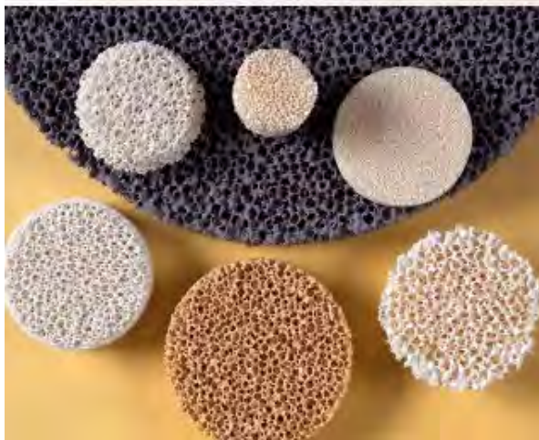
Figuur 35 keramische filters, bron [28]
