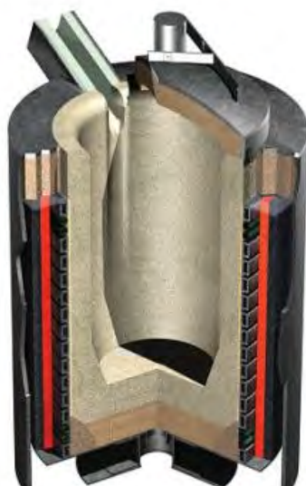
Figuur 15 kernloze inductieoven, bron [79]
