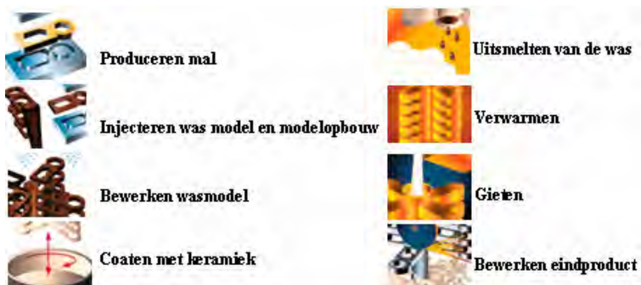
Figuur 25 productie verloren was methode, bron:www.cirex.nl
