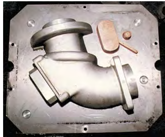
Figuur 20 stalen model voor maken boven en ondervorm, bron [74]
