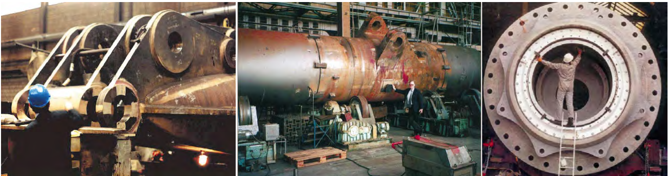
Figuur 55 gietstuk bovenkant A-frame, bron [49]
