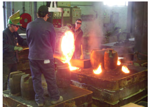
Figuur 22 vullen zandgietvorm bij Soester Gieterij
