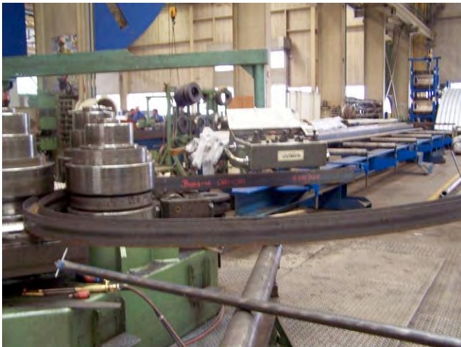
3. Profielbuigen van een HE 100A bij Kersten Europe BV in Wanssum (links) en het eindresultaat: een HE 100A met een buigstraal van 1910 mm (rechts).
