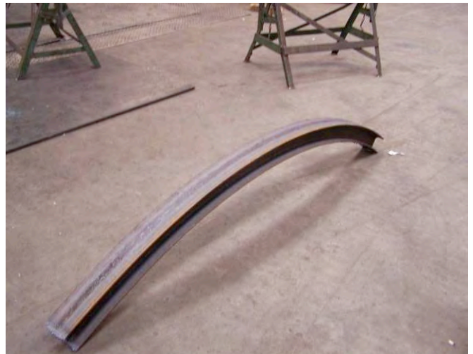
3. Profielbuigen van een HE 100A bij Kersten Europe BV in Wanssum (links) en het eindresultaat: een HE 100A met een buigstraal van 1910 mm (rechts).
